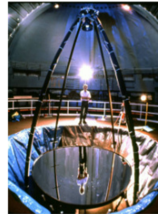
Télescope à miroir liquide utilisé par la NASA jusqu'en 2002 pour mesurer les débris spatiaux à orbite basse.
